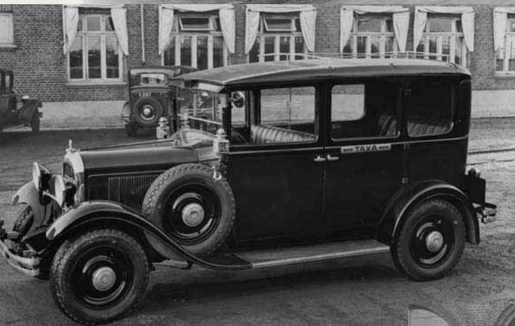
1929. En AC4, med typisk Taxa-karosseri, fotograferet i baggården hos Citroën. I forhold til standardmodellen var taget hævet betydeligt, hvilket også var tilfældet med de senere Rosalie-modeller (se næste opslag). Da de nye, lave Traction-modeller kom frem i 1934 betød det et foreløbigt slut med Taxa. Bilerne var for lave i.h.t. regulativerne, selvom den indvendige kabinehøjde formentlig har været tilstrækkelig.
